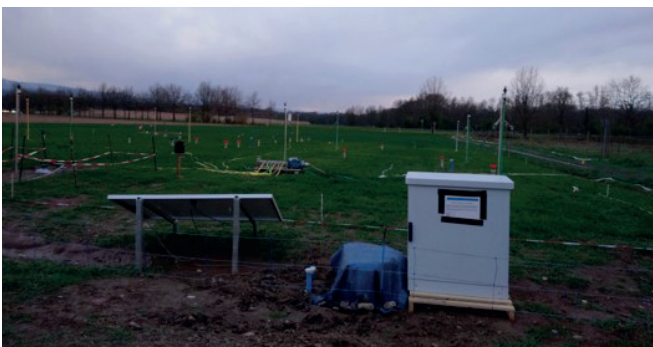
Bild 1: Der Online-Grundwasserbiomonitor im Labor, Wasserwerk und Feld zur Bewertung und Überwachung der Grundwasserqualität hinsichtlich potentiell toxischer Auswirkungen von Schadstoffen und Chemikaliengemischen.
