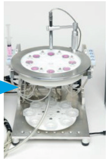
Messkammerblock mit 8 Mikrokammern (Copepoden)
